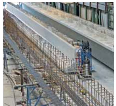
Vorgespanntes Trägerelement aus Beton mit CEM III/A 52,5 N
