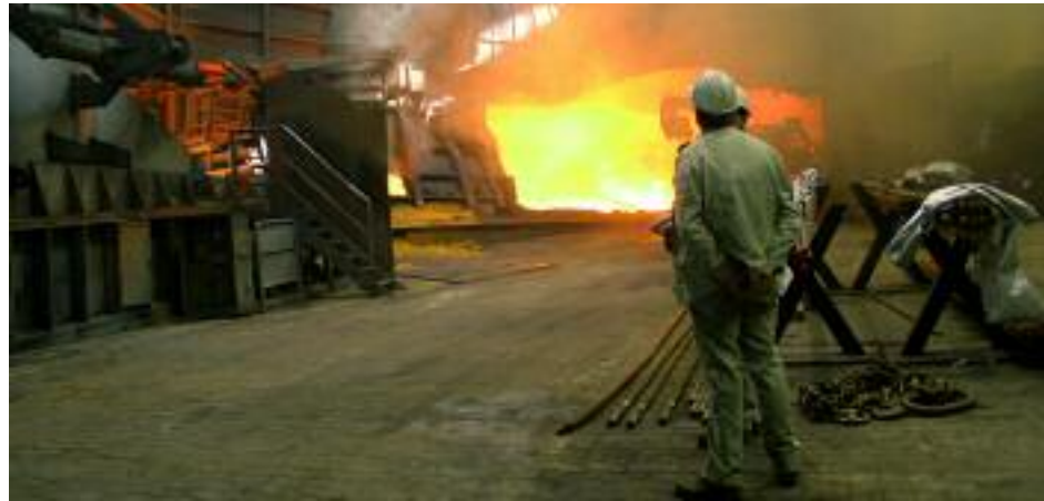
Hochofenabstich in Duisburg: Aus der ausfließenden Schlacke wird Hüttensand hergestellt.
