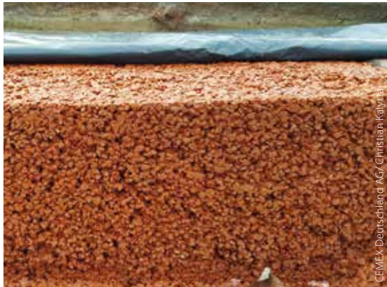
Pervia® Deco im Querschnitt
